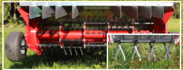
Rotor mit 120 X-Zinken und 6 frei pendelnden Zinkenreihen
