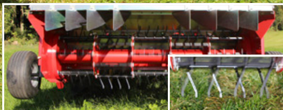
Rotor à fléaux, 120 fourchons, réparti sur 6 rangées pendulaires
