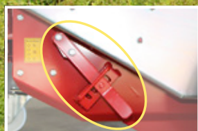
L'effet de conditionnement est réglable par un râteau à 4 postions
